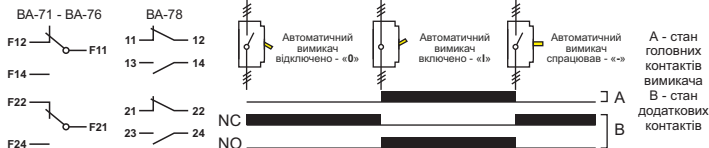
Мал. 2.6 - принципова схема та діаграма положень додаткових контактів
